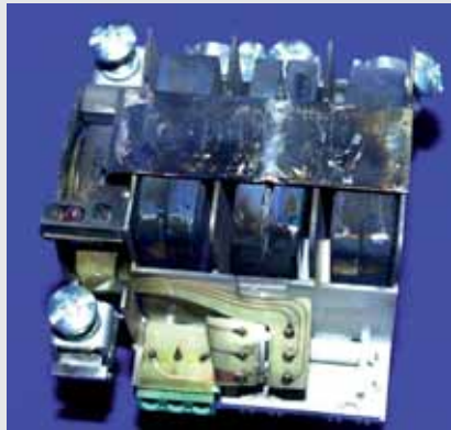
Rys. 5 Ogranicznik nr 2 - deklarowana wytrzymałość udarowa dla prądu 10/350 \mu s 12,5kA - stwierdzono uszkodzenie przy 5,2 kA
