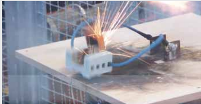
Rys. 5 Eksplozja ogranicznika podczas badań
