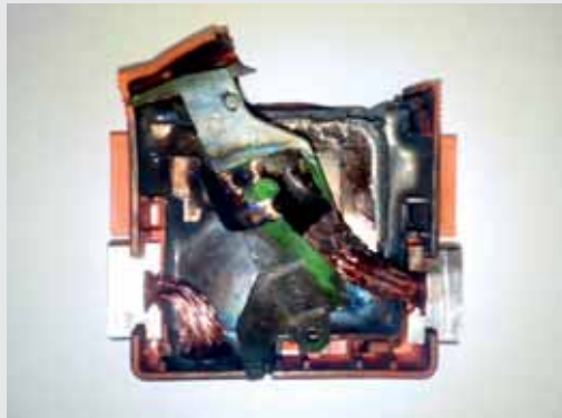
Rys. 4 Ogranicznik nr 1 - deklarowana wytrzymałość udarowa dla prądu 10/350 \mu s 12,5kA - stwierdzono uszkodzenie przy 6,7 kA
